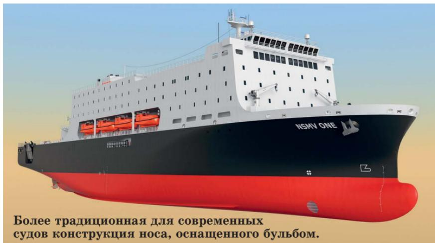
Более традиционная для современных судов конструкция носа, оснащенного бульбом.
