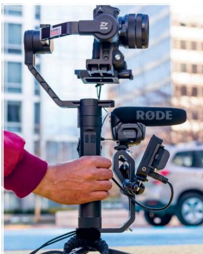
Стедикам освободил камеру от плотного прикосновения к глазу оператора для кадрирования. Это позволяет увеличить диапазон движений, а используя внешний накамерный контрольный монитор большого размера, можно более точно и тонко настроить фокусировку.
