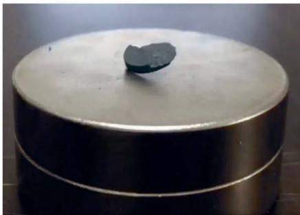
Левитация немагнитного материала в магнитном поле. На фото справа видно, что сверхпроводник LK-99 касается одним краем подложки. Согласно теории, такого быть не должно.
