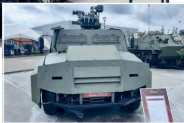
Показали и сверхзащищенный вариант бронированного автомобиля «Тигр-М». У него, в частности, усилено бронирование передней части корпуса, прикрыто лобовое стекло, доработаны двери. Появились накладные бронированные щиты, защищающие от пуль стрелкового оружия и осколков мин и снарядов.
