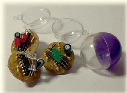
Рис. 8. Фото электронных переключателей и разъемных шариков.
