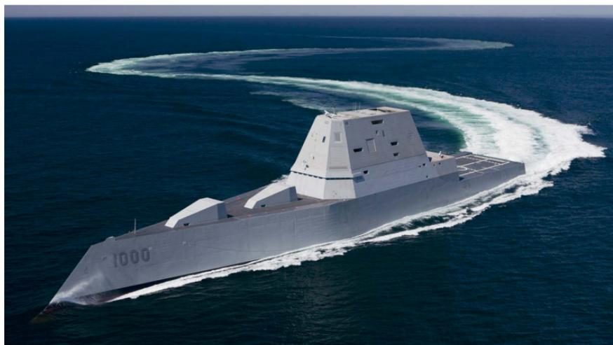
Корабль Zumwalt оснащен инверсным носом, который, однако, лишен свойственной дизайну X-Vow округлости, а также имеет завал бортов внутрь, почти как у броненосцев класса «Бородино».
