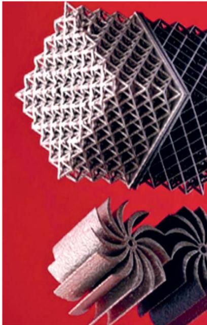
Ученые же объединили метод производства сплавов с современной технологией 3D-печати. Поскольку в таком процессе материалы расплавляются и затвердевают очень быстро по сравнению с традиционной металлургией, получается совсем другая микроструктура. Она выглядит как сеть и состоит из чередующихся слоев. «Перестройка этой обычной микроструктуры
