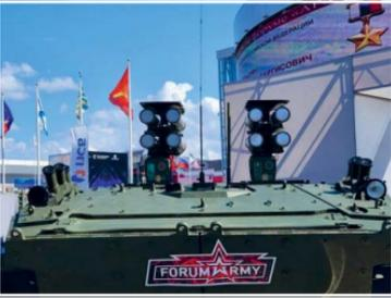
Противотанковый ракетный комплекс «Корнет-ЭМ» собран на базе броневедомо-мобиля «Тайфун».
