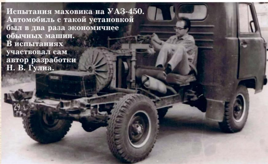
Испытания маховика на УАЗ-450. Автомобиль с такой установкой был в два раза экономичнее обычных машин. В испытаниях участвовал сам автор разработки Н. В. Гулиа.
